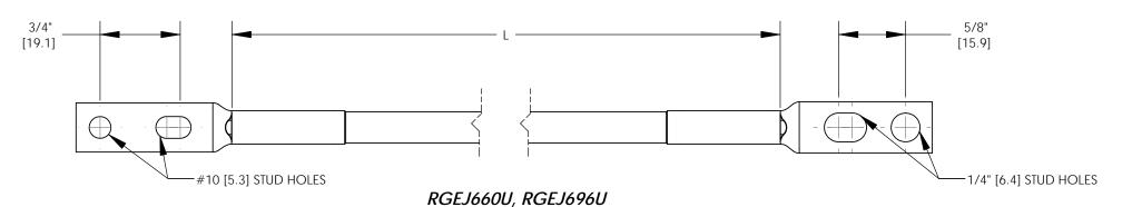
FACTORY CRIMPED #6 AWG/16mm SQ. JUMPER WIRE ASSEMBLY (QTY. 1) INCLUDES: LCC6-14JAW (QTY. 1) LCC6-10ABW (QTY. 1) #6 AWG/16mm SQ. WIRE - GREEN/YELLOW INSULATION
