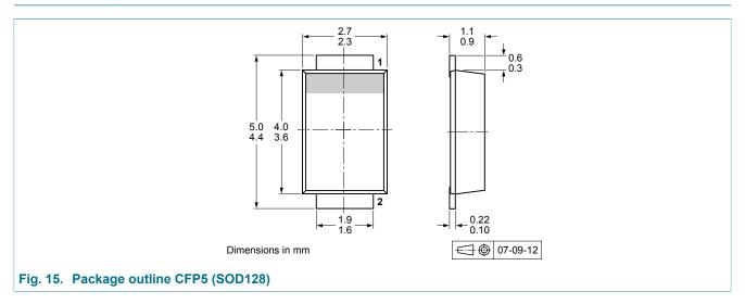
40 V, 3 A low VF Trench MEGA Schottky barrier rectifier
